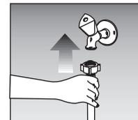
Не подключайте машину с одним шлангом подачи воды к горячей воде. Если машина подключена Y частью к двум шлангам подачи воды и для машин с одним шлангом подачи воды температура воды будет более 40°C, машина может переключиться на защитный режим.
