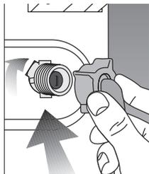
Ваша машина будет работать эффективно, если минимальное давление воды в водопроводном кране будет составлять 1 атмосферу, а максимальное 10 атмосфер. Фактически 1 атмосфера равна подаче 8 литров воды в минуту при полном открытии водопроводного крана.
