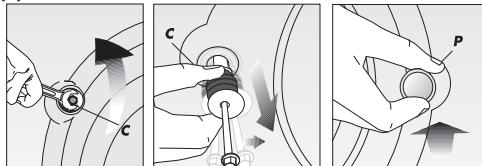
1. Ослабьте болты с маркировкой "С", откручивая их соответствующим гаечным ключом против часовой стрелки.
